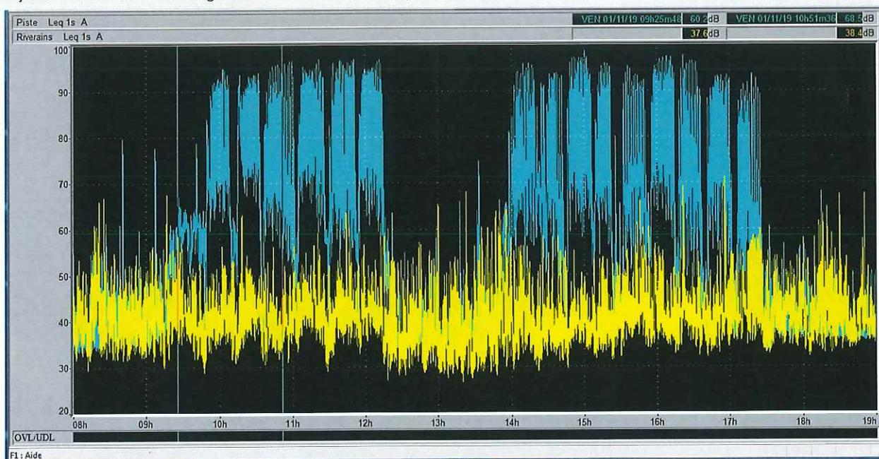
Ouverture du circuit : Mesures et Analyses réalisées selon méthode contrôle stipulée dans la norme NFS 31-010 et ce en 2 points simultanément : au dessus de la ligne d'arrivée du circuit et au centre de Ledenon.
